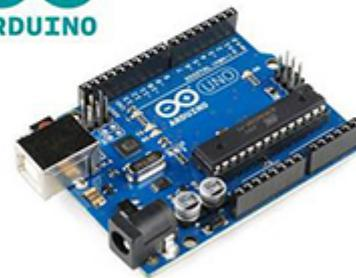
E' un piccolo computer, facile da programmare e da collegare al mondo reale. Vi si possono collegare **sensori** (pulsanti, potenziometri, ecc.) e **attuatori** (LED, motori, ecc.) e programmarne il funzionamento.
